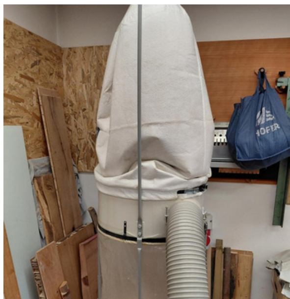
Začetno stanje - klasičen sistem odsosovanja z vrečastim filtrom
