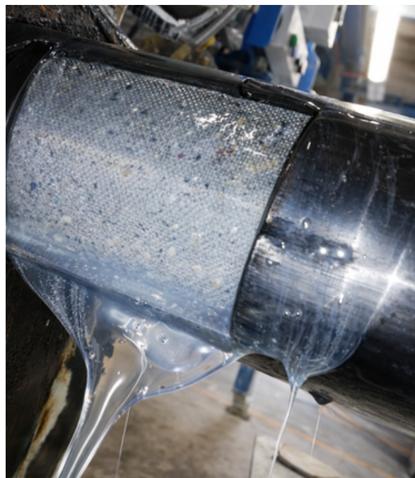
Mrežica v procesu – učinkovito zadrževanje nečistoč v realnih pogojih.
